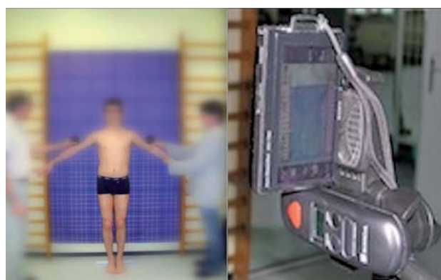
Figure 2. Le sujet est positionné pieds joints sur un repère au sol (mire en aluminium), bras écartés à 60°. Le laser est fixé sous l'appareil, à 55 mm à la verticale de l'objectif.
